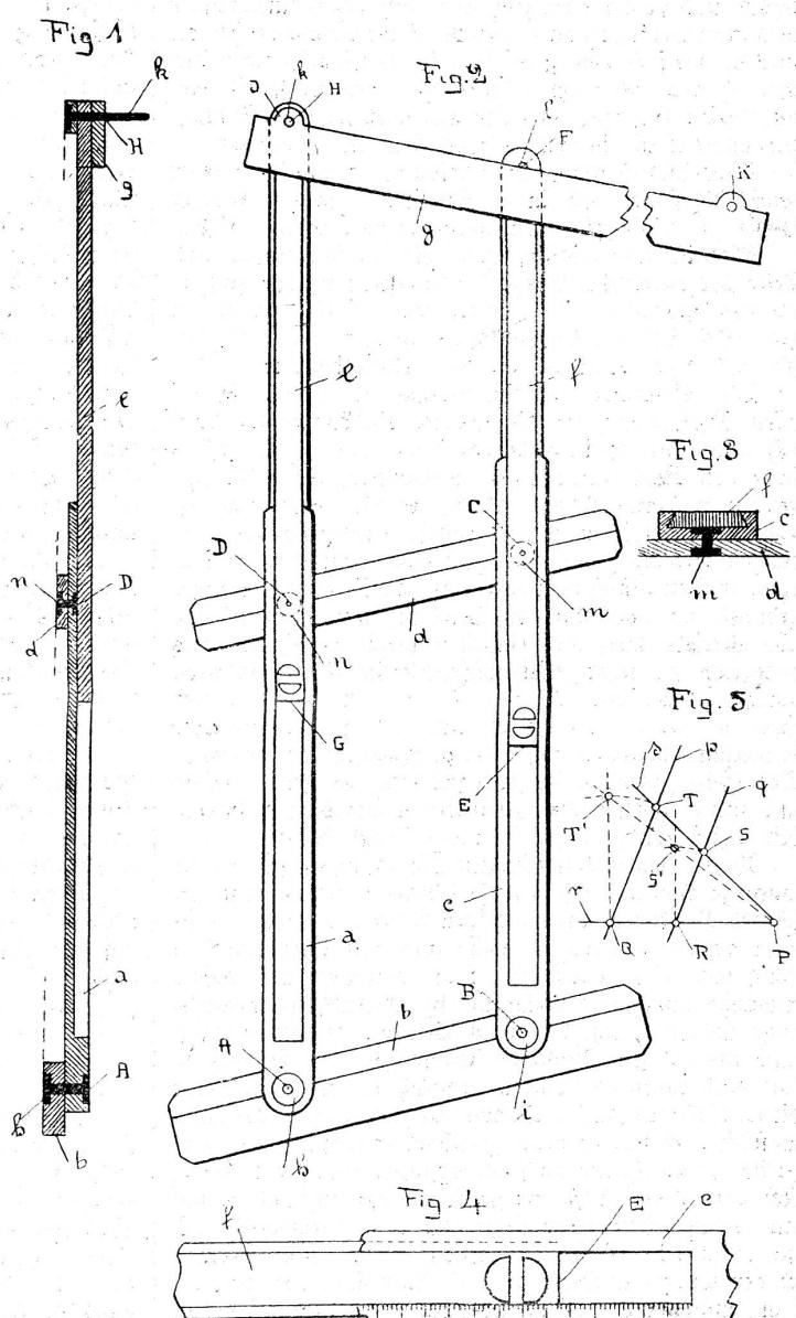
sucht. Die Rechnung für die Einstellung von BF gestaltet sich dann nach der Formel  $BF = \frac{AH \cdot BP}{AB + BP}$  (Vertauschung von BF mit RS, AH mit QT, BT mit RP und AB mit QR).
