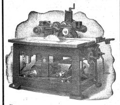
Kreissäge mit mechanischem Vorschub
