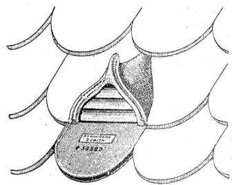
erhalten Sie durch Verwendung meiner patent. Ventilation-Luftziegel.
