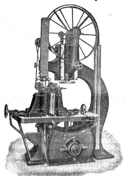
Trenn-Bandsäge mit selbsttätigem Walzeneinzug.
