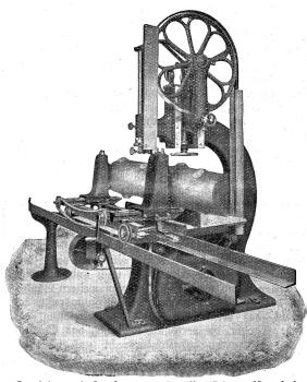
Bandsäge mit Laufwagen mit selbsttätigem Vorschub.
