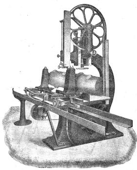
Bandsäge mit Laufwagen mit selbsttätigem Vorschub.
