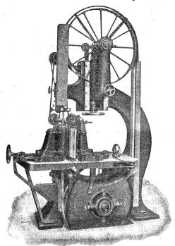
Trenn-Bandsäge mit selbsttätigem Walzeneinzug.
