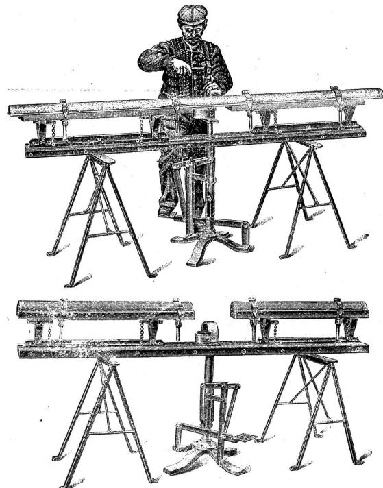
Diese neueste und einfachste Känelniet- und Lötmachine dient zum raschesten und exakten Nieten und Löten, sowie Aufzälen von Dachkäneln. Zur Bearbeitung dieser Arbeiten existierten bis jetzt nur eine große Anzahl von Hülfswerkzeugen, denen aber allen eine gewisse Umständlichkeit anhaftet.
