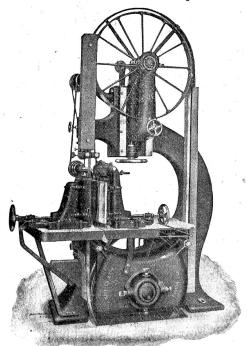
Trenn-Bandsäge mit selbsttätigem Walzeneinzug.
