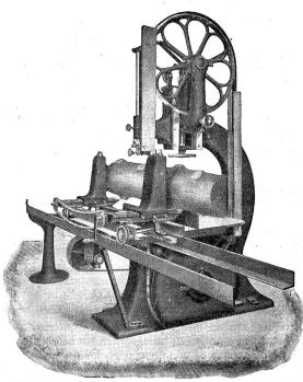
Bandsäge mit Laufwagen mit selbsttätigem Vorschub.
