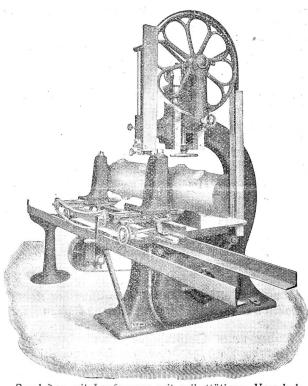
Bandsäge mit Laufwagen mit selbsttätigem Vorschub.
