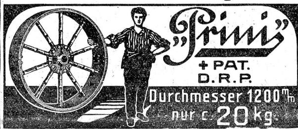
2 teil. Transmissions-Scheibe „PRINI B“ mit Gussnabe, Bambusspeichen, Kranz aus Langholzfournierplatten. Durchm. 250—1200 mm bis 15 PS Gewicht Breite 80—200 mm bei 200 Touren 3—24 kg<sup>1</sup>
