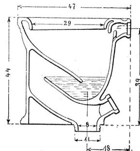
Fabriken) erstellt wurden, unterscheidet man in der Konstruktion zwei Arten; nämlich Nieder spül- und Aus spül system.
