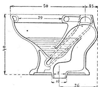
Das Absauge-Klosett ist ein Niederspül-Klosett, dessen Spülung durch eine besondere Konstruktion unterstützt wird, die dadurch den Syphon zum Leersaugen
