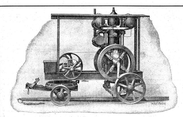
LOKOMOBILEN 2—16 PS für Benzin-, Benzol-und Rohölbetrieb ::
