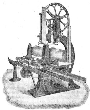
Bandsäge mit Laufwagen mit selbsttätigem Vorschub.
