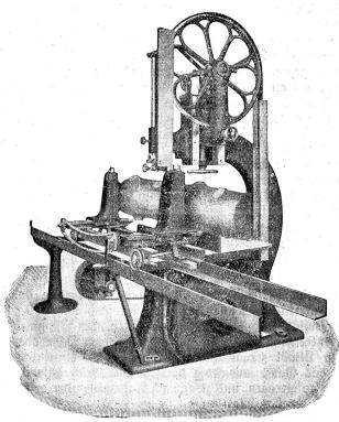
Bandsäge mit Laufwagen mit selbsttätigem Vorschub.
