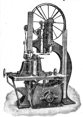
Trenn-Bandsäge mit selbsttätigem Walzeneinzug.
