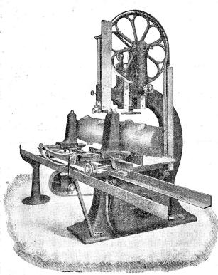
Bandsäge mit Laufwagen mit selbsttätigem Vorschub.
