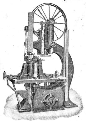
Trenn-Bandsäge mit selbsttätigem Walzeneinzug.
