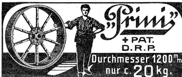
2 teil. Transmissions-Scheibe „PRINI B“ mit Gussnabe, Bambusreichen, Kranz aus Langholzfournierplatten. Durchm. 250—1200 mm bis 15 PS Gewicht Breite 80—200 mm bei 200 Touren 3—24 kg
