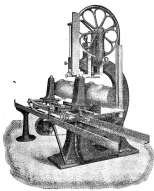
Bandsäge mit Laufwagen mit selbsttätigem Vorschub.
