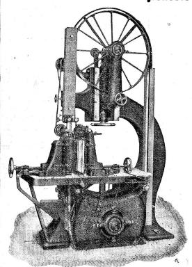
Trenn-Bandsäge mit selbsttätigem Walzeneinzug.
