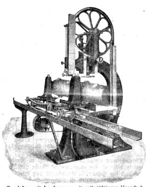
Bandsäge mit Laufwagen mit selbsttätigem Vorschub.
