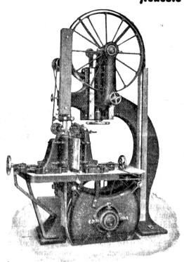
Trenn-Bandsäge mit selbsttätigem Walzeneinzug.
