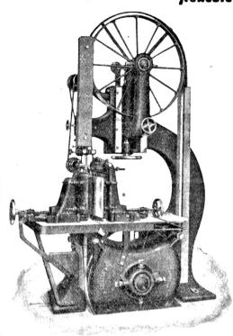
Trenn-Bandsäge mit selbsttätigem Walzeneinzug.
