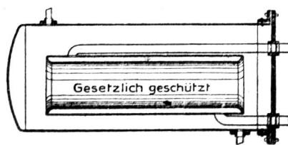
Für indirekte Heisswasserbereitung autogen geschweisst. Dieser Flüssigkeitserhitzer besteht aus einem Doppelzylinder aus stark. Eisenblech mit Zu- und Rücklaufleitungen. Derselbe kann wie obenstehende Abbildung zeigen, in jeden beliebigen Boiler eingesetzt werden. Nur durch dieses System ist das grösstmögliche Quantum Heisswasser für Bad-, Abwasehzwecke etc. zu erzielen. Beste und billigste Bezugsquelle. [586] Prospekte gratis.
