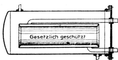
Für indirekte Heisswasserbereitung autogen geschweisst. Dieser Flüssigkeitserhitzer besteht aus einem Doppelzylinder aus stark. Eisenblech mit Zu- und Rücklaufleitungen. Derselbe kann wie
