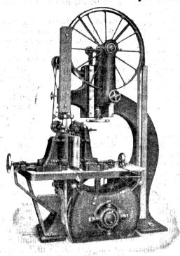
Trenn-Bandsäge mit selbsttätigem Walzeneinzug.
