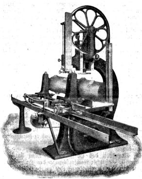
Bandsäge mit Laufwagen mit selbsttätigem Vorschub.
