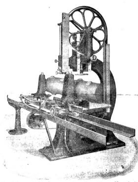
Bandsäge mit Laufwagen mit selbsttätigem Vorschub.
