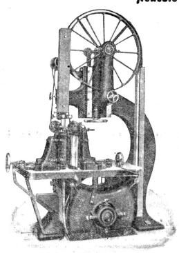
Trenn-Bandsäge mit selbsttätigem Walzeneinzug.
