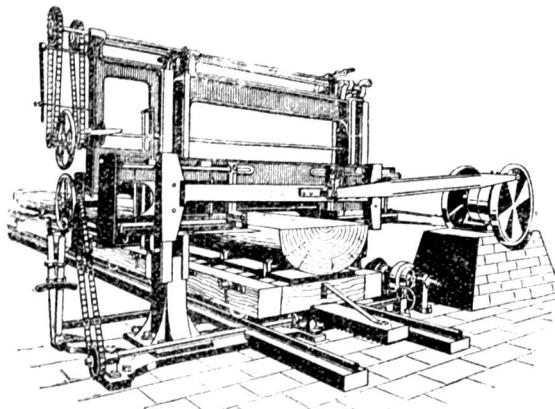
rahmen besonders zur Geltung. Dabei braucht das Doppelgatter nur den Platz eines einfachen. Man kann die Produktionsfähigkeit der Maschine dadurch noch weiter steigern, daß man Doppelangeln in einen oder beide Sägerahmen einspannt; das Gatter kommt dann in der Leistung schon einem Vollgatter sehr nahe.
