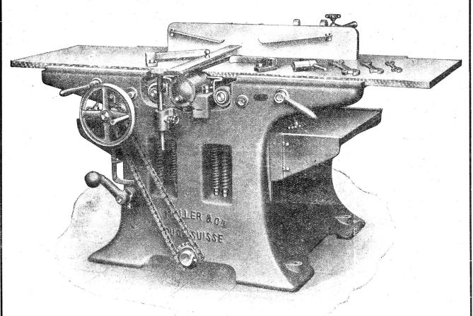
Kombinierte Abricht- und Dickehobelmaschine mit Kugellagerung; beide Abrichtetische, aus extra starken Flussplatten bestehend, einzeln in der Köhe stellbar mit patentierten ... federnden Tischwalzen, in Kobelbreiten von 360, 450, 530 und 600 mm. ...
