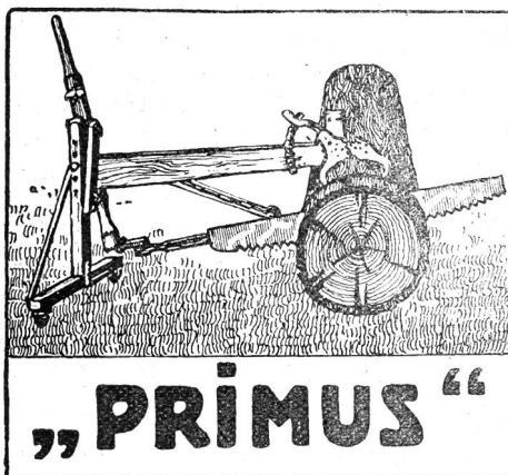
„Primus“ ist leicht transportabel, kann in der Höhe von  $4\frac{1}{2}$ –27 Zoll und auf flachem oder steilem Terrain stehend angewendet werden. Das Blatt der Säge besteht aus dünnem amerikanischen Stahl und bricht nicht. „Primus“ ist eingerichtet für Stämme bis zu  $3\frac{1}{2}$  Meter Dicke.
