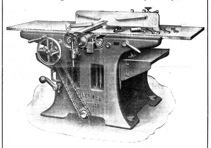
Kombinierte Abricht- und Dickehobelmaschine mit Kugellagerung; beide Abrichtetische, aus extra starken Flussplatten bestehend, einzeln in der Köhe stellbar mit patentierten
