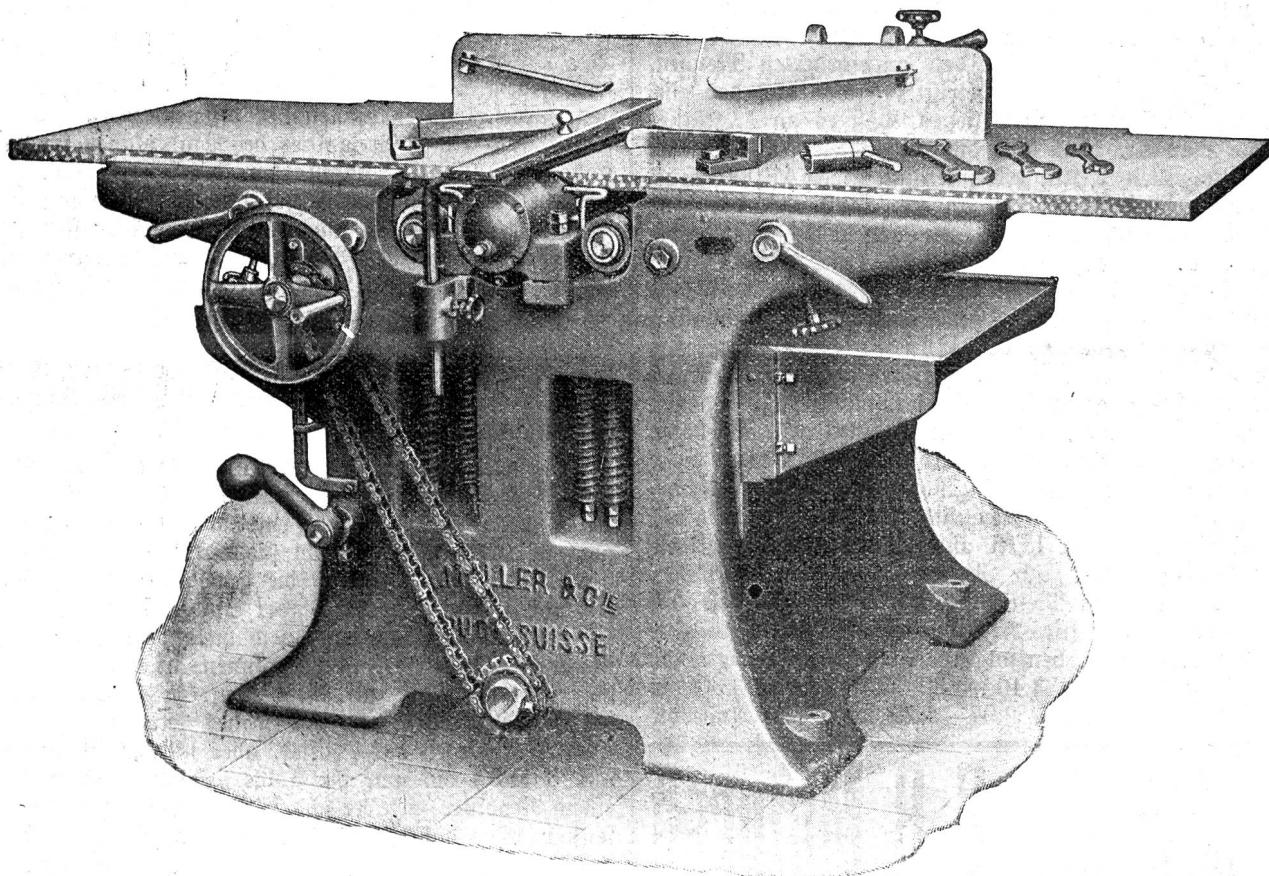
Kombinierte Abricht- und Dickehobelmaschine mit Zugellagerung; beide Abrichtetische,
