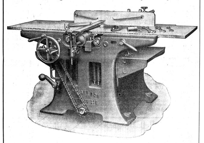
Kombinierte Abricht- und Dickehobelmaschine mit Kugellagerung; beide Abrichtetische, aus extra starken Flussplatten bestehend, einzeln in der Köhe stellbar mit patentierien ... federnden Tischwalzen, in Kobelbreiten von 360, 450, 530 und 600 mm.
