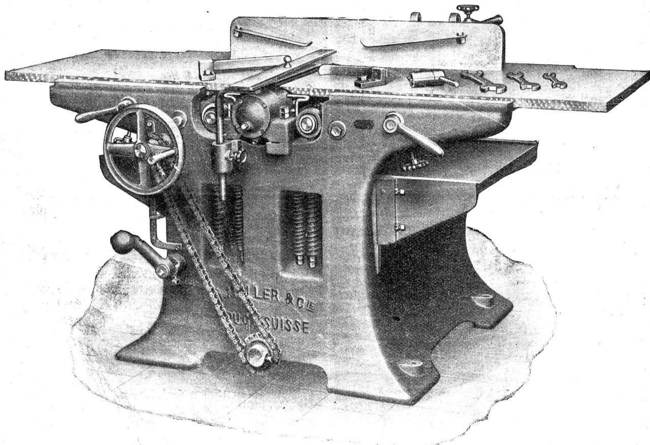
Kombinierte Abricht- und Dickehobelmaschine mit Zugellagerung; beide Abrichtetische, aus extra starken Flussplatten bestehend, einzeln in der Höhe stellbar mit patentierten
