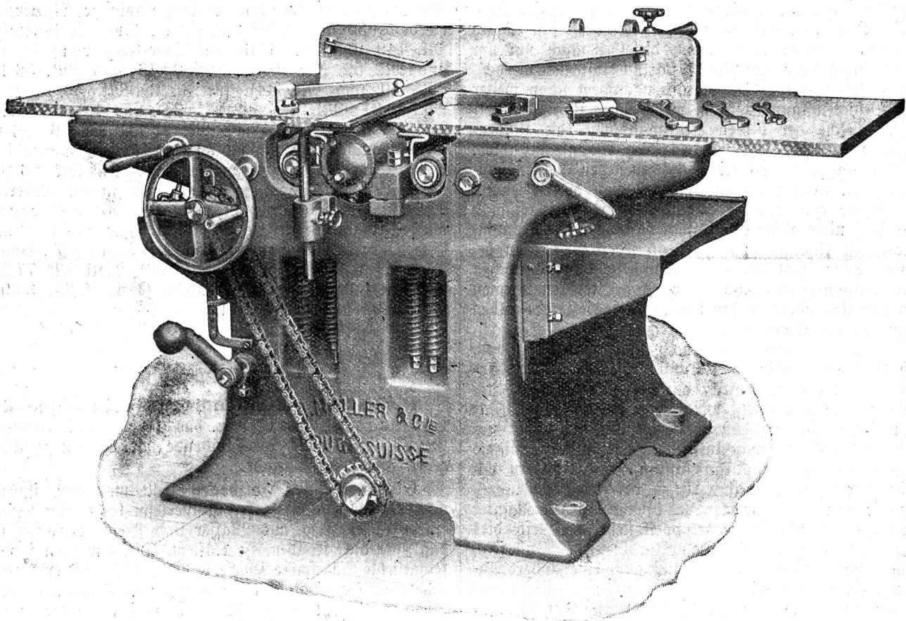
Kombinierte Abricht- und Dickehobelmaschine mit Kugellagerung; beide Abrichttische, aus extra starken Flussplatten bestehend, einzeln in der Höhe stellbar mit patentierten ∴ federnden Tischwalzen, in Hobelbreiten von 360, 450, 530 und 600 mm. ∴
