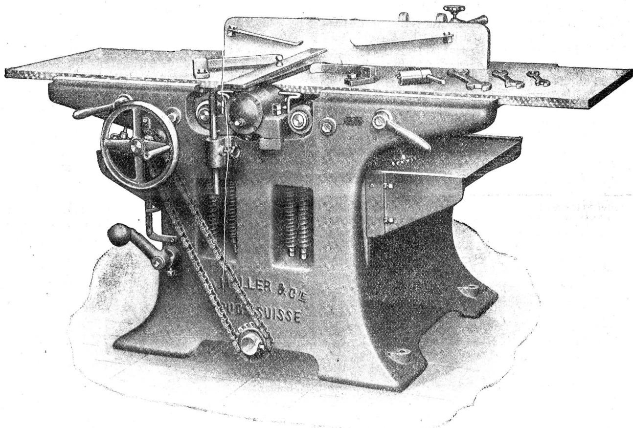
Kombinierte Abricht- und Dickehobelmaschine mit Kugellagerung; beide Abrichtetische,
