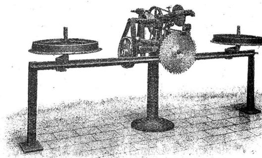
der verschiedenen Zahntypen und Zahngrößen ist noch eine Vorrichtung vorhanden mit einer Skala, welche jedermann die sofortige Einstellung der Maschine auf die gewünschte Zahntyp und Zahngroße ermöglicht. Das Heben und Senken der Schmirgelscheibe, sowie das Verschieben des Sägeblattes erfolgt bei der Maschine automatisch, jedesmal, wenn ein Zahn geschliffen ist.
