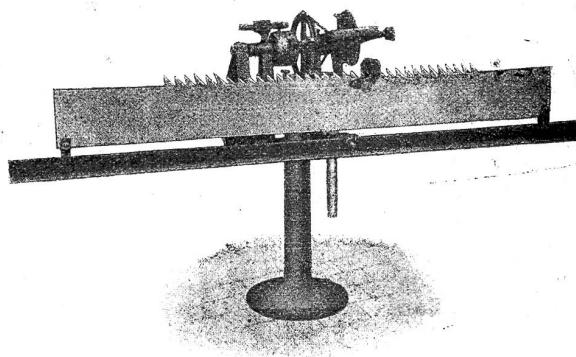
Maschine nicht nur eine Hebung und Senkung der Schmirgelscheibe, sondern auch eine geneigte Einstellung derselben bezüglich des Sägeblattes. Dadurch ist in der einfachsten Weise das Schleifen von unterschnittenen Zahnkanten möglich geworden und es hat diese Ausbildung der Maschine auch noch den Vorteil, daß beim Schleifen solcher Kanten die Schmirgelscheibe sich durch die Abnutzung von selbst schärft. Jede gebräuchliche Zahntyp kann mit der Maschine geschliffen werden. Zum Schleifen
