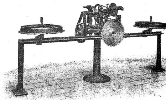
der verschiedenen Zahnformen und Zahngrößen ist noch eine Vorrichtung vorhanden mit einer Skala, welche jedermann die sofortige Einstellung der Maschine auf die gewünschte Zahnform bzw. Zahngroße ermöglicht. Das Heben und Senken der Schmirgelscheibe, sowie das Verschieben des Sägeblattes erfolgt bei der Maschine automatisch, jedesmal, wenn ein Zahn geschliffen ist.
