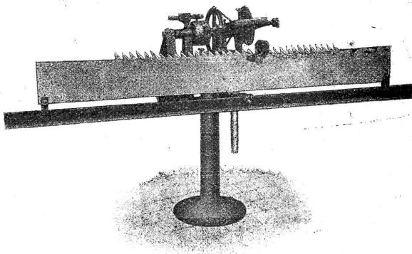
Maschine nicht nur eine Hebung und Senkung der Schmirgelscheibe, sondern auch eine geneigte Einstellung derselben bezüglich des Sägeblattes. Dadurch ist in der einfachsten Weise das Schleifen von unterschnittenen Zahnkanten möglich geworden und es hat diese Ausbildung der Maschine auch noch den Vorteil, daß beim Schleifen solcher Kanten die Schmirgelscheibe sich durch die Abnutzung von selbst schärft. Jede gebräuchliche Zahnform kann mit der Maschine geschliffen werden. Zum Schleifen
