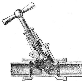
angeschraubten Wasserleitungsröhr, das Wasser hat durch das ganze Gehäuse hindurch ungehinderten, freien Weg und wird nirgends gestaut. Angestellte Proben haben ergeben, daß Hähne nach dieser Konstruktion fast 60% mehr Wasser geben, als Hähne bisheriger Ausführung.
