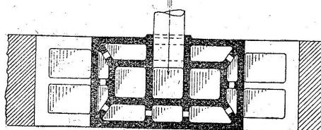
Die wenigen Fugen des Schofer-Kamins sind ein außerordentlicher Vorzug und sichern diesem eine weit über gemauerten Kaminen stehende Stellung, denn bei 2,1 m Höhe hat das Schofer-Kamin nur zwei nicht nach innen oder außen durchgehende Fugen, während ein gemauertes Kamin gleicher Größe 27 Lager- und 168 Stoßfugen hat.
