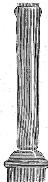
da das Anstoßen oder Anschlagen an den besonders empfindlichen Rändern des Zylinders verhütet wird. Beim Anzünden der Lampe ist darauf zu achten, daß die Flamme zunächst nur bis an den Kniff geht, man muß sie in dieser Lage eine kurze Zeit lang lassen und kann dann allmählich die gewünschte starke Lichtentwicklung herbeiführen. In kurzen Worten zusammengefaßt sind die Hauptvorteile des Culinanz-Zylinders folgende;
