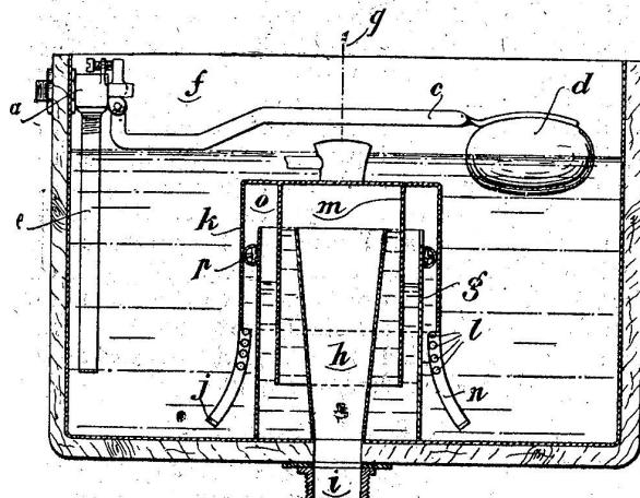
ring. Der Closet-Spül-Kasten kann in jeder beliebigen Höhe, auch direkt hinter dem Closet angebracht werden. Ein Überlaufen des Wassers im Kasten ist vollständig ausgeschlossen, da die im Raum  $\sigma$  komprimierte Luft solches absaugt, sobald der Wasserspiegel über den Schwimmer hinausgeht.
