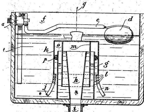
ring. Der Closet-Spül-Kasten kann in jeder beliebigen Höhe, auch direkt hinter dem Closet angebracht werden. Ein Überlaufen des Wassers im Kasten ist vollständig ausgeschlossen, da die im Raum o komprimierte Luft solches absaugt, sobald der Wasserspiegel über den Schwimmer hinausgeht.
