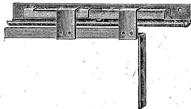
laufen, wobei sich die an der oberen Schiene hängende Tür erstaunlich leicht und sicher fortbewegt. Die Laufbahn der Kugeln ist durch Stifte begrenzt, die ein Verlaufen der Kugeln oder Kippen der Tür völlig ausschließen.
