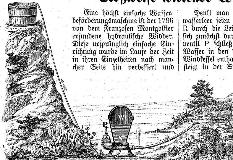
Eine höchst einfache Wasserbeförderungsmaschine ist der 1796 von dem Französischen Montgolfier erfundene hydraulische Widder. Diese ursprünglich einfache Einrichtung wurde im Laufe der Zeit in ihren Einzelheiten nach mancher Seite hin verbessert und
