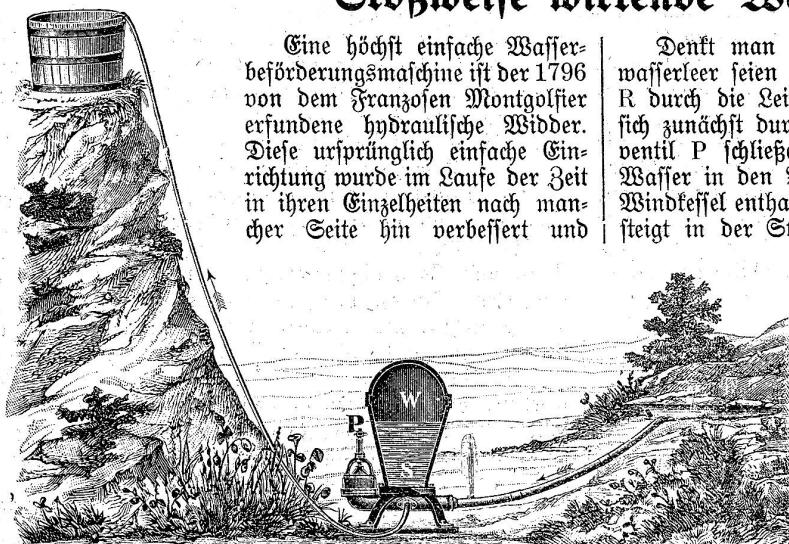
Eine höchst einfache Wasserbeförderungsmaschine ist der 1796 von dem Französischen Montgolfier erfundene hydraulische Widder. Diese ursprünglich einfache Einrichtung wurde im Laufe der Zeit in ihren Einzelheiten nach mancher Seite hin verbessert und
