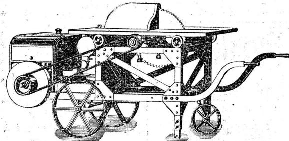
Fahrbare Kreissägen mit Benzinnmotoren
