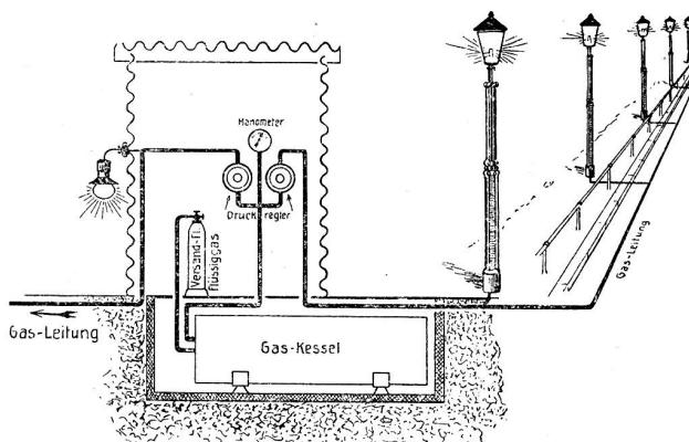
Flüssiggas wird in feiner Hinsicht von der Außenluft beeinträchtigt und kann beliebig aufgespeichert und an jeder gewünschten Stelle verwendet werden. Weder das Gas noch die Verbrennungsprodukte greifen das Metall an, daher sind die Brenner, Gebläse und Zubehörteile lange Zeit gebrauchsfähig.
