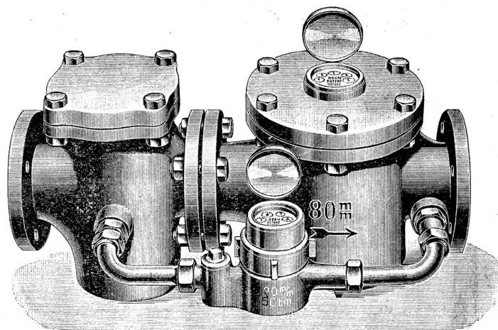
Wassers zum großen Messer geschlossen bleibt und so fließt dasselbe durch den in der Umgangsleitung angebrachten kleinen Wassermesser, welcher dasselbe mit größter Genauigkeit registriert. Bei größeren Wasserentnahmen arbeiten beide Wassermesser gleichzeitig. Um den Verbrauch des durchgeflossenen Wassers festzustellen, sind natürlich beide Messer abzulesen und zu addieren.
