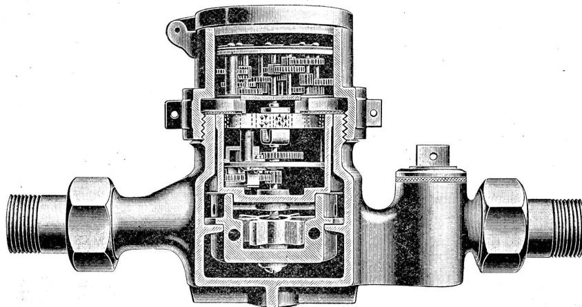
Die Einförmung des Wassers auf das ebenfalls eigenartig konstruierte Hartgummi-Flügelrad ist kreisstrahlförmig (konzentrisch), daher Wegfall des verderblichen einseitigen Antriebs.
