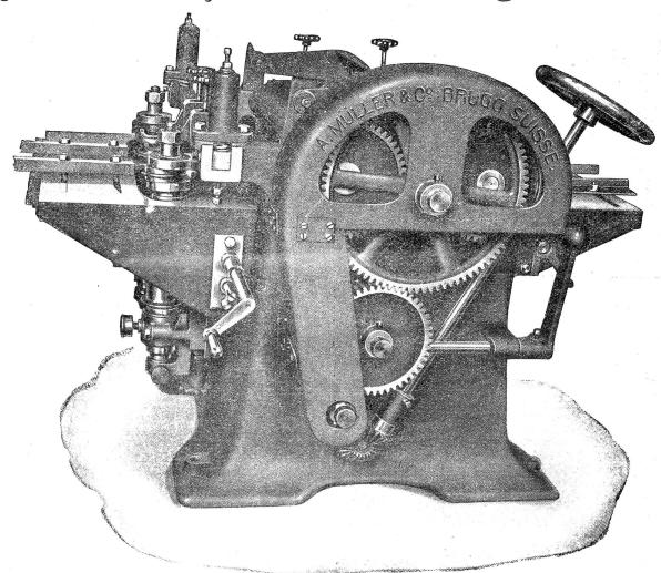
Neueste modernste Konstruktionen, mit 2861 d Ringschmierung, automatisch gefrästen Triebmit 2861 d Triebrädern, geschliffenen Wellen etc.
