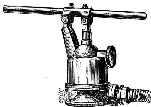
Unempfindlichkeit gegen Sand-, Schlamm- und Kies führendes Wasser usw. infolge Fehlen von Zylinder und Kolben.
