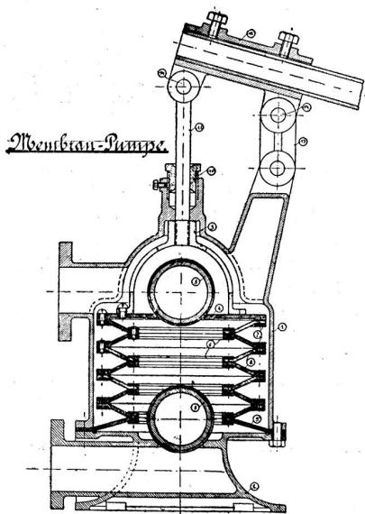
mit einer eigenartigen Membrane ausgerüstet und besitzt eine hohe Leistungsfähigkeit sowohl hinsichtlich Quantum als auch Förderhöhe. Die beistehenden Figuren zeigen das Innere dieser Neuheit. Es sind mehrere ringförmige Einzelmembrane mittels Metallringen zu einem elastischen Balgkörper versteift. Diese Metallringe verstetigen den Balg gegen die Wirkung des Flüssigkeitsdruckes. Die neuen Prinzipien, die hier zu Grunde liegen, sind folgende:
