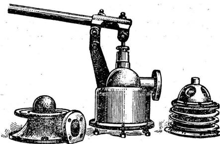
verwendet wird. Schon verhältnismäßig geringe Druckhöhen von 10—12 m verringern ihre Lebensdauer außerordentlich. Die Beanspruchungsweise ist folglich in der Regel eine so unzulässige, daß eine große Haltbarkeit der Membran bisheriger Konstruktion einfach ausgeschlossen ist.
