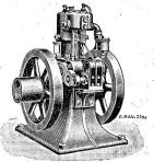
Magnetzündung Kugel-Regulator Automatische Schmierung
