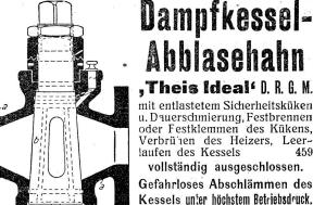
mit entlastetem Sicherheitsküken u. Dauerschmierung, Festbrennen oder Festklemmen des Kükens, Verbrühen des Heizers, Leer-laufen des Kessels 459
