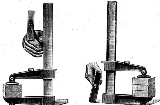
das Festklemmen geschieht durch Hammerschlag, ebenso das Lösen, was einem bedeutenden Zeitgewinn gleichkommt. Die Spannkraft der Schlagzwinge ist außerordentlich groß und bleibt stets die gleiche. Dabei ist die Zwinge fast unverwüstlich und, was sie noch besonders beachtenswert macht, billiger, als alle bekannten Momentschraubzwingen. Es liegen über die praktische Verwendbarkeit bereits die schmeichelhaftesten Zeugnisse vor. Unter anderen drückt sich z. B. ein Schreinermeister wie folgt aus:
