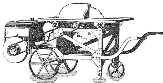
Fahrbare Kreissägen mit Benzimotoren
