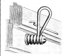
Haben einen **angenehmen geräuschlosen** Drehgang und fallen nicht zwischen Flügel und Rahmen, weil durch die Riegelschraube in Spannung gehalten.
