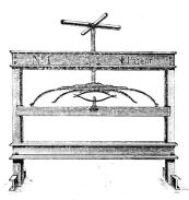
Die 36 mm ftarte Spindel wird durch einen Schlüffel in Kreuzform aus Eisenrohr gedreht. Die lichte Ent= fernung zwischen ben Seitenftreben beträgt 101 cm, die lichte Bohe bis zur Druckplatte 28 cm.
