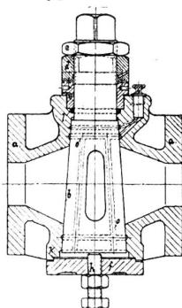
Mit entlastetem Sicherheitskükens und Dauerschmierung, Festbrennen oder Festschlümmen des Kükens, Verbinden des Heizers, Leerlaufen des Kessels 459
