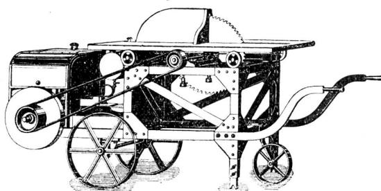
Fahrbare Kreissägen mit Benzinmotoren
